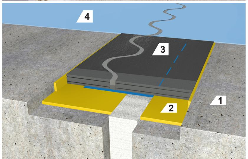
1 Konstruktionsbeton 2 Verbundkleber 3 Fugenprofil WGX 20/50 4 Beschichtung/
