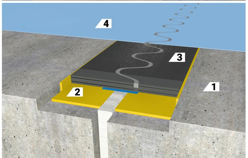
1 Konstruktionsbeton 2 Verbundkleber 3 Fugenprofil ST 20/30 4 Beschichtung/
