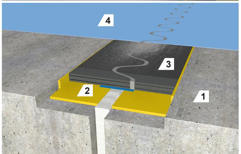
1 Konstruktionsbeton 2 Verbundkleber 3 Fugenprofil AC 20/30 4 Beschichtung/
