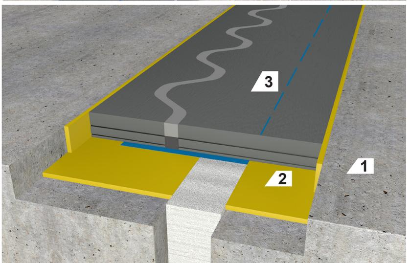
1 Konstruktionsbeton 2 Verbundkleber 3 Fugenprofil WGX 30/50
